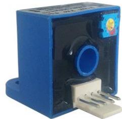
应用电磁感应原理的电流传感器，能在隔离条件下对交流电流信号实现开关量输出，实现过流进行保护的功能。
