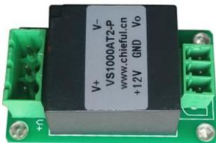
应用光电隔离器原理的电压传感器，能在电隔离条件下测量直流及脉动直流信号的电压。
