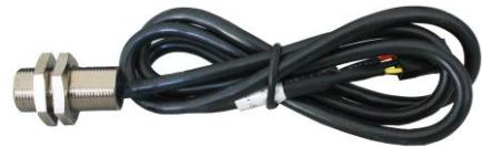
HCL201 型是一种新型的霍尔齿轮传感器，用于检测速度、角度、转速等。它采用独特的信号处理方式能使传感器与齿轮间的工作间隙达到 3mm 以上，精确的占空比信号输出，工作频率低至 0Hz。
