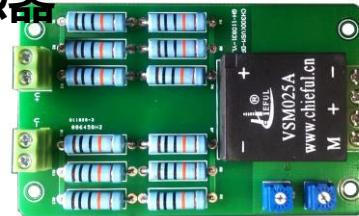
应用霍尔效应闭环原理的电压传感器，能在电隔离条件下测量各种信号的电压。
