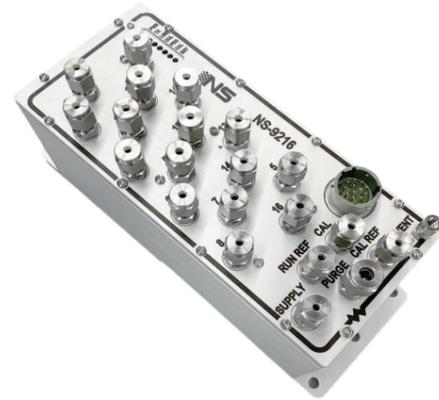
NS-9216电子压力扫描阀是一种高性能一体式气体压力测量装置，用于多通道干燥无腐蚀性气体的压力测量，其内部集成了压力传感器和气路校准阀。NS-9216具有16个测量通道，每个通道使用单独的气体压力传感器，每个传感器内部都具有记忆全部校准数据的嵌入式记忆电路芯片，精度高达±0.05%，通过内部调零校准、量程校准或多点校准功能来维持高精度。
